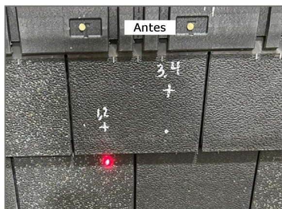
FIGURA 2 - Antes y Después del Impacto en Tejas Expuestas a Rayos UV (1000h UV)
