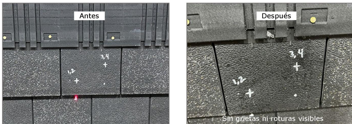
FIGURA 3 - Impacto Antes/Después: UV + Calor (1000h UV + 1000h 240°F)
