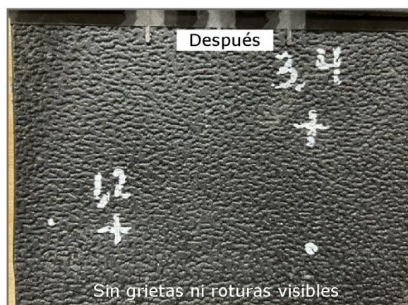
FIGURA 2 - Antes y Después del Impacto en Tejas Expuestas a Rayos UV (1000h UV)
