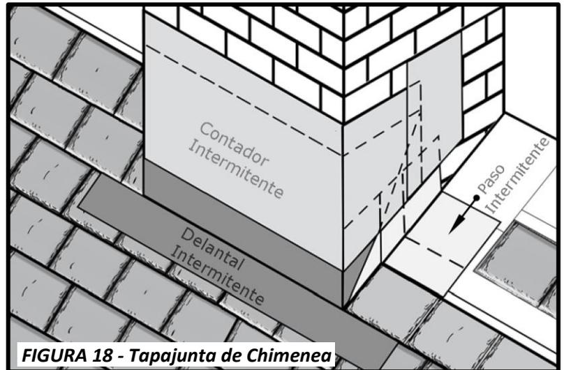
**FIGURA 18 - Tapajunta de Chimenea**
