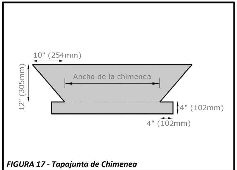
**FIGURA 17 - Tapajunta de Chimenea**
